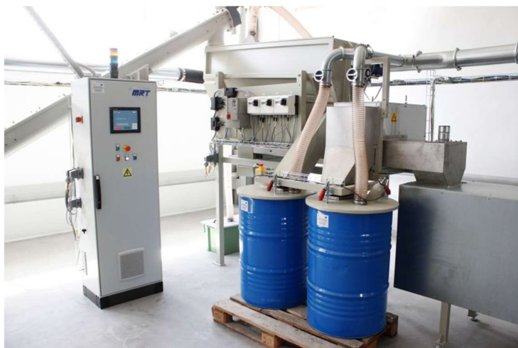
Rysunek 9.3. Sprzęt linii przetwarzania odpadów zawierających rtęć w „Bodnarówce” jest własnością szwedzkiej firmy „MRTSystem AB”
