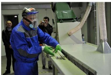
Rysunek 9.4. Sprzęt do dekontaminacji lamp rtęciowych i innych przedmiotów zawierających pary rtęci
