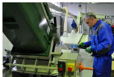
Rysunek 9.4. Sprzęt do dekontaminacji lamp rtęciowych i innych przedmiotów zawierających pary rtęci
